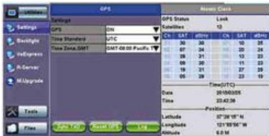
Anche l'ora del giorno GPS (**ToD**) può essere usata per impostare accuratamente l'ora e la data locale nel tester, usando la funzione **Sync ToD** che applicherà la correzione per il fuso orario locale prima di applicarla all'orologio in tempo reale del tester. Questa indicazione di tempo viene adoperata per i rapporti e gli eventi, ma non per i test dove il fattore tempo è determinante.
