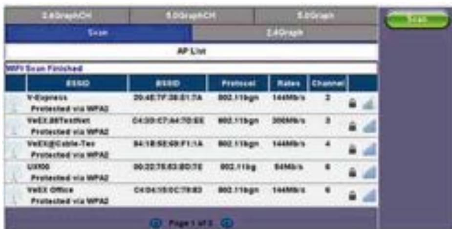
1. Inserite l'adattatore WiFi nella porta USB. Aspettate almeno 30-45 secondi in modo che l'unità possa rilevare l'adattatore wireless e caricare il driver del software.
