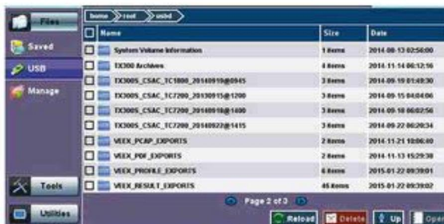
Potete accedere allo strumento USB nella scheda **Utilities** sotto **Files** e poi **USB**. Permette una gestione essenziale della memoria USB in modo tale da navigare ed interagire con il suo contenuto senza che sia necessario utilizzare un PC.
