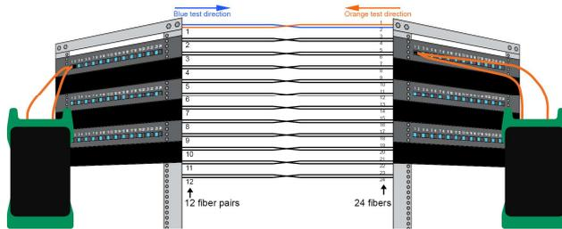
In modalità PAIR, la certificazione avviene, per entrambe le lunghezze d'onda, simultaneamente su entrambe le fibre della coppia, senza richiedere l'intervento dell'operatore.
