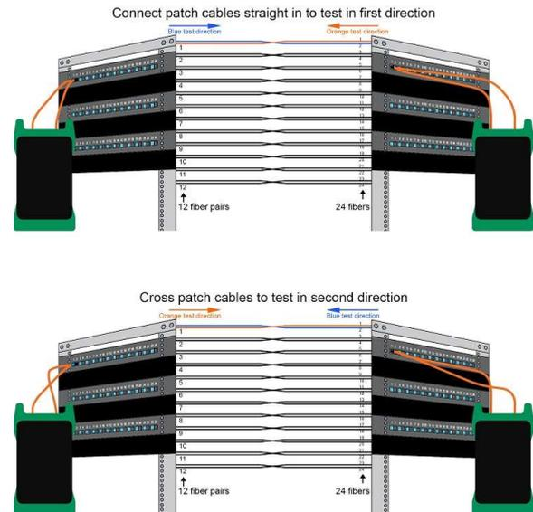
In modalità BIDI, la certificazione avviene su entrambe le fibre della coppia, a ciascuna lunghezza d'onda e in entrambe le direzioni. La misura richiede l'inversione manuale dei connettori a metà del processo.
