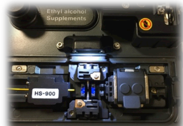
Fig.11 - Posizionamento del supporto nella giuntatrice
