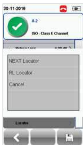
Localizzatore – Per abilitare premere il pulsante [SETUP] → Test Settings (Impostazioni di test) → Test Options (Opzioni test) → Locator (Localizzatore)
