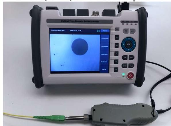
Lo strumento è dotato di serie di funzioni VFL (luce laser rossa visibile), OPM (power meter), LS (sorgente ottica) e FiberScope. Quest'ultima funzione richiede una sonda apposita con interfaccia USB, fornibile a richiesta.
