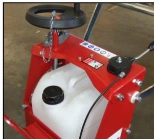
Una tubazione, dotata di rubinetto manuale di regolazione, porta l'acqua per il raffreddamento e l'abbattimento polveri ai due fianchi del disco diamantato di taglio: in questo modo la polvere generata dal disco diventa fanghiglia che viene sparata indietro e trattenuta a terra dal paraspruzzi in gomma presente nella parte posteriore del carter del disco.
