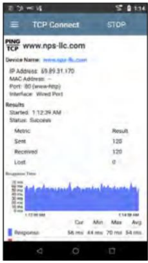
Test HTTP su un server Web con analisi del tempo di risposta dell'utente finale
