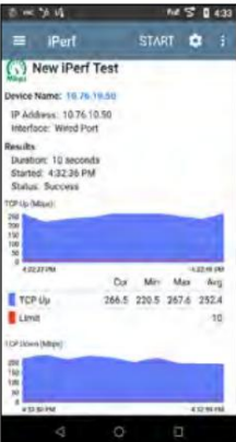
Test di velocità effettiva iPerf con Frame TCP o UDP
