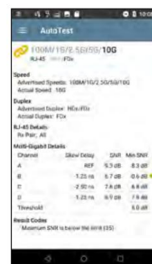
La misurazione SNR del cablaggio viene convalidata Collegamenti multigig
