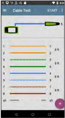
Test del cavo con Wiremap che rileva la distanza dal guasto, inclusa la schermatura del cavo
