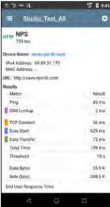
Test HTTP su un server Web con analisi del tempo di risposta dell'utente finale
