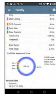
Il test HTTP rivela i tempi di risposta dei servizi basati su cloud/web
