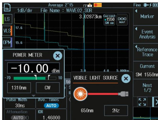
Esempio di multitasking con OTDR, misuratore di potenza ottica e sorgente di luce visibile
