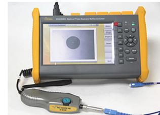
EFD con sonda microscopica (fornita a parte)
