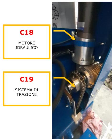
MOTORE IDRAULICO DI AVANZAMENTO
