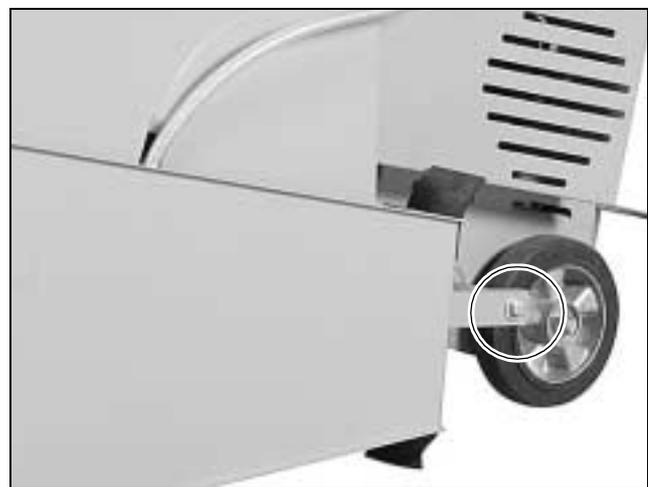
Fig. 4.12 Vite di fissaggio del coprilama esterno
