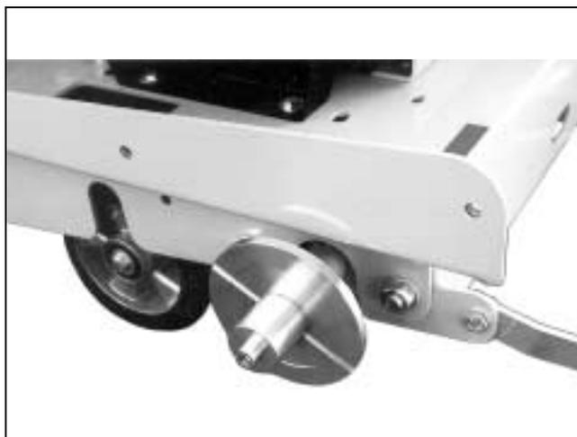
Fig. 4.19 Sistema di tenuta dell'albero di taglio sul lato opposto (rivestimento non in figura)
