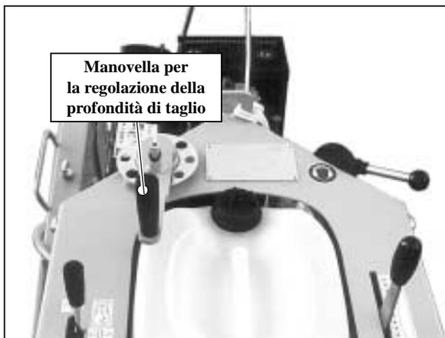
Fig. 4.10 Regolazione manuale della profondità di taglio
