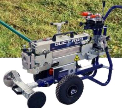
Le sue caratteristiche di potenza ed affidabilità permetto l'inserimento di sonde ad una distanza ed una velocità altrimenti non raggiungibili con i metodi manuali tradizionali. Grazie alla spinta fornita dal compressore idraulico fornito nel kit (100 bar), la DuctRod Rapid spinge (o tira) la sonda con fino **200 kg di forza** con continuità, ad una velocità fino a **80 m/minuto**, rendendo l'attività veloce e priva di difficoltà.
