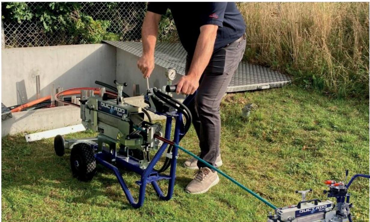
La DuctRod Rapid è un innovativa macchina realizzata da Fremco per la spinta di sonde passacavo in vetroresina all'interno di condotte.
