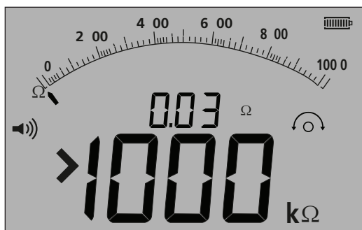
Fig 11: Esempio di risultato di test di continuità
